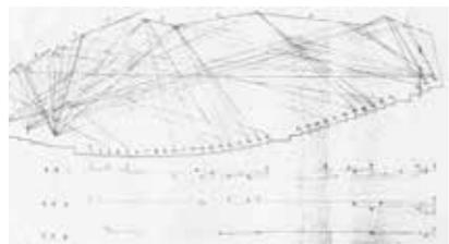
反射音線図 石橋文化ホール音響設計
