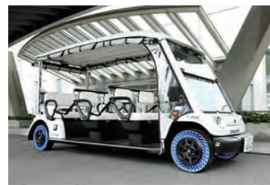
グリーンスローモビリティ 低速で公道を走ることができる電動車
